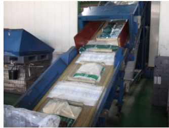
材料搬送コンベアに乗せ、 途中で金属探知 大型粉砕機で一定サイズに粉砕
